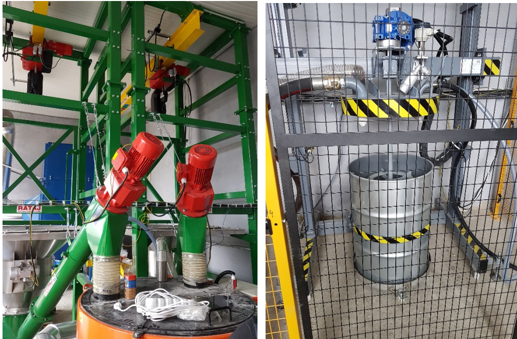
სურ.1 რადიოაქტიური ნარჩენების ცემენტირების მინი-საწარმოს დანადაგარები
