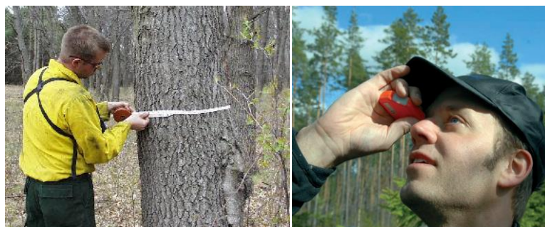
სურათი 60 . ტყეკაფზე საშუალო დიამეტრისა და საშუალო სიმაღლის დადგენის მეთოდი
